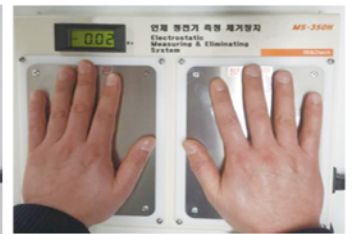
* 방전판 인체 정전기 측정값:0.02kV
