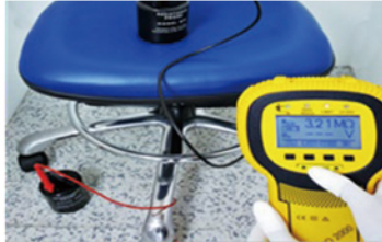
* 제전의자와 제전 타일 통전저항 측정
